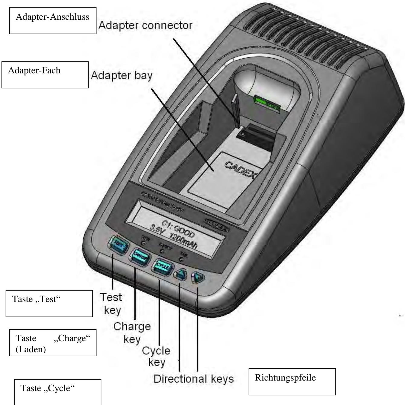
Abbildung 11: C5100-Batterietester – Vorderseite – Übersicht
