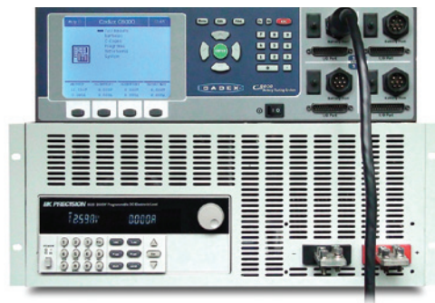
控制外部数字负载以测试高电流/大功率应用
