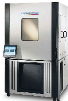
控制环境模拟室，测试温度循环对电池性能的影响
